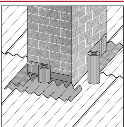
**С задней части трубы** низ ленты нужно дополнительно прижать фрагментом листа и прикрепить гвоздями в каждую волну.
