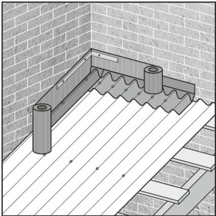
**Торцевое (нижнее) примыкание** закройте покрывающим фартуком для Ондулина Смарт, низ фартука прибивайте гвоздями по каждой волне в дополнительную обрешётку. Верх фартука проклейте лентой Ондуфлеш-Супер шириной не менее 10 см, прижав верх ленты к стене металлической планкой.
