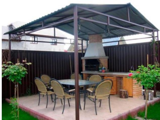
**Поликарбонат.** Позволяет сделать полупрозрачный навес практически любой формы. Но из-за размягчения при нагревании располагать навес следует не ближе 1,5 м от огня. Между дымоходом и крышей из поликарбоната также нужно проложить термостойкий материал.
