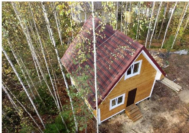
Конструкция состоит из двух одинаковых или разноразмерных скатов, которые сходятся в коньке. В плоскости между скатами располагаются фронтоны, где могут быть прорезаны оконные проемы или обустроен балкон. Двухскатный тип распространен в индивидуальном домостроении. Несмотря на отсутствие архитектурных изысков, крыши с двумя скатами из разных типов кровли выглядят эстетично.
