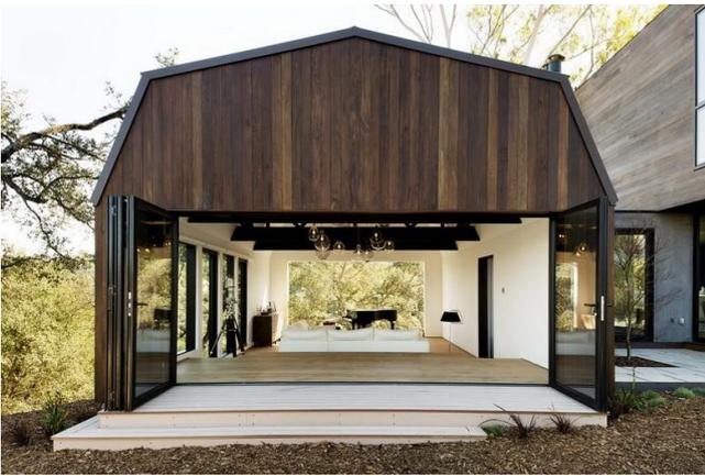
На фото — нетривиальный вариант дизайна частного коттеджа, каркас которого собран из металлического профиля, крыша имеет ломаную конфигурацию, а фронтоны обшиты пестрой древесиной.
