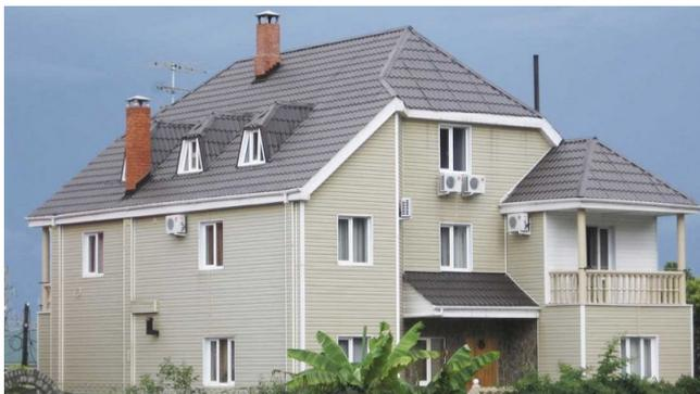
Внутри такой крыши можно легко соорудить мансарду или чердачное помещение. Обычно это полтораэтажные загородные дома с большим углом наклона скатов. За счет полувальмы уменьшают нагрузку, оказываемую ветром на конструкцию крыши. Также полувальмы хорошо защищают балкон или окна на фронте от осадков. Голландский тип крыши подходит как для коттеджей, предназначенных для круглогодичного проживания, так и для дач.
