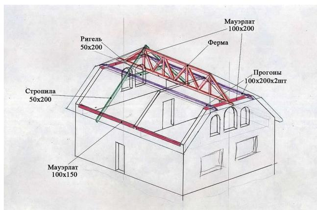
Основу конструкции полувальмовой крыши составляет стропильная система. Она должна быть достаточно прочной, чтобы выдерживать свой вес, а также справляться со снеговой и ветровой нагрузкой. Перечислим её главные элементы:
