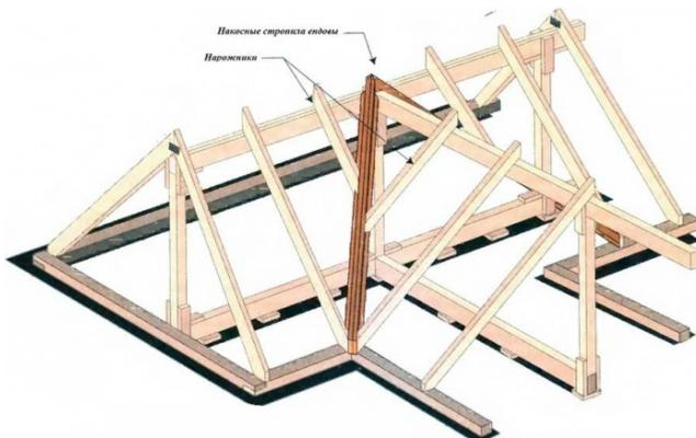
Самым простым вариантом считается трёхщипцовая крыша. Она сооружается на прямоугольной коробке, имеющей пристройку. Более сложные конструкции включают в себя элементы других видов крыш (вальмовая, купольная и т.д.). Многощипцовую крышу состоит из нескольких стропильных систем, связанных между собой. В результате получается несколько скатов и фронтонов. Несмотря на сложность, строители предлагают варианты проектов для недорогих загородных домов с многощипцовой крышей.
