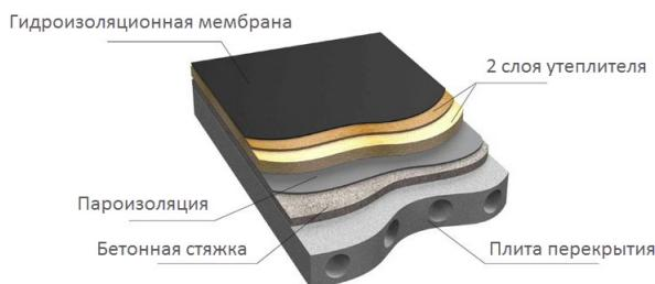
Рассмотрим на примере плоской крыши для гаража или производственного объекта.
