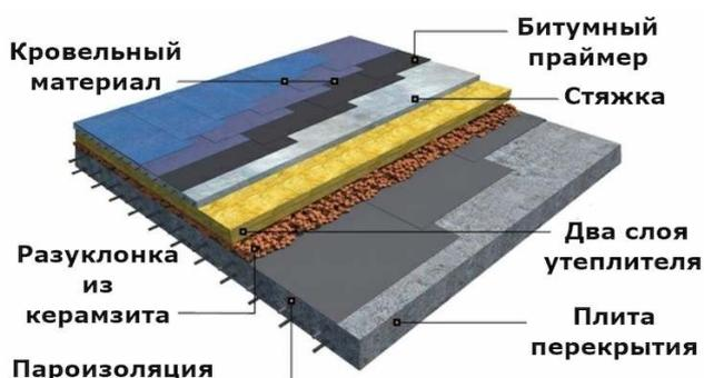
На схеме выше один из вариантов устройства пирога плоской крыши. В качестве пароизоляции рекомендуем использовать Ondutiss PRO Flat Roof. Это высококачественная пароизоляционная плёнка от компании ONDUTISS,
