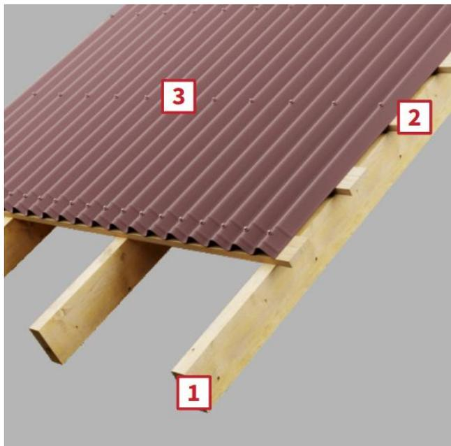
С точки зрения монтажа, это один из самых простых вариантов. Холодная крыша применяется для веранд, летних беседок, и конечно же, для жилых домов, где утепление сделано по чердачному перекрытию. Для холодных крыш монтируется стропильная система с обрешёткой, на которую крепится кровельный материал. В данном случае на схеме выше используется Ондулин Смарт.
