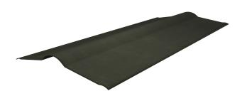
Конёк (коньковая планка) необходим, чтобы обеспечить нормальный воздухообмен в подкровельном пространстве и защитить его от попадания влаги. Устанавливается он на стыке скатов и является самой верхней частью крыши. Он также защищает кровлю и подкровельное пространство от грязи и пыли.
